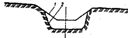
Рис. П.8.40. Размывы открытых водоотводов (канал, кюветов и др.); 1 — построчный поперечный профиль канала; 2 — очертание размываемой канавы
