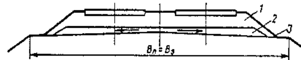
Рис. П.5.6. Типовое очертание основной площадки изначально двухпутного земляного полотна из глинистых грунтов: 1 — щебеночный балласт; 2 — песчано-гравийный балласт (песчаная подушка); 3 — основная площадка
